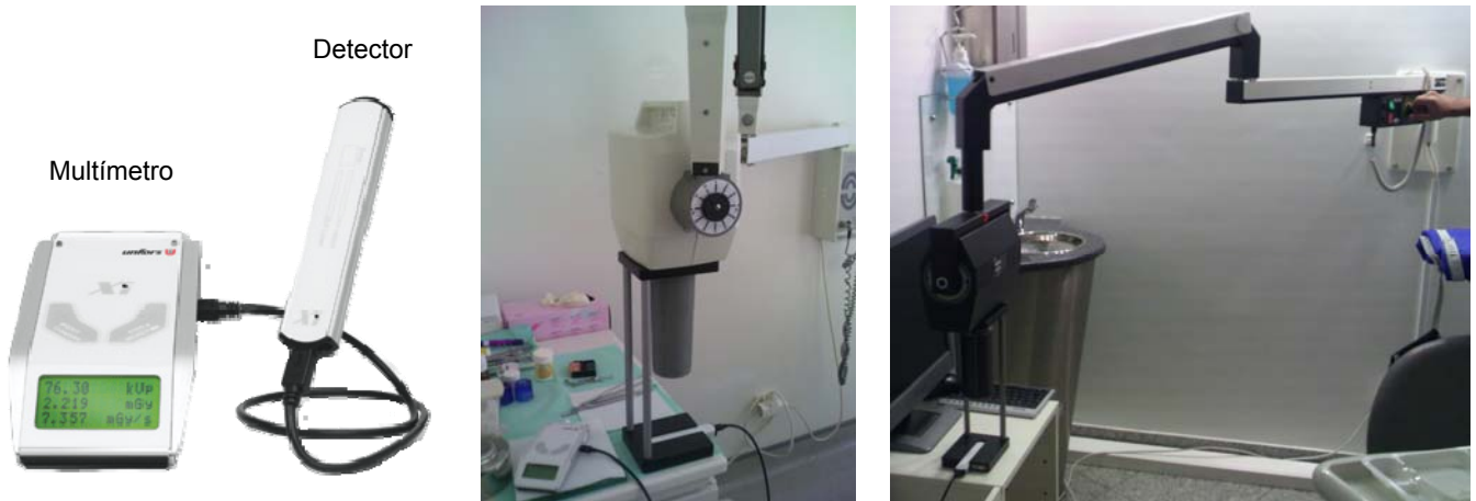
Fig 3. Medição de kV, dose, tempo e filtração total utilizando o multímetro Unfors Xi Platinum Plus.
